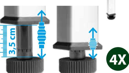
Adjustar è un sistema di livellamento brevettato che permette una regolazione molto semplice dell'altezza delle gambe di appoggio mediante un nuovo metodo meccanico di trasmissione della spinta. Grazie a questo meccanismo è possibile evitare che i mobili pendano in una direzione. Ogni camperista conosce questo problema e quanto sia laborioso e noioso regolare le gambe dei tavoli che devono essere spostati in alto, in basso e lateralmente, soprattutto quando ci si trova su terreni irregolari.
